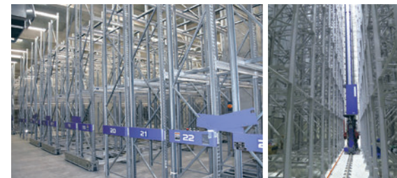
大阪舞洲2号棟。保管効率が高く、省スペースを実現する移動ラック (左)。省力化の進んだ自動倉庫 (右)
